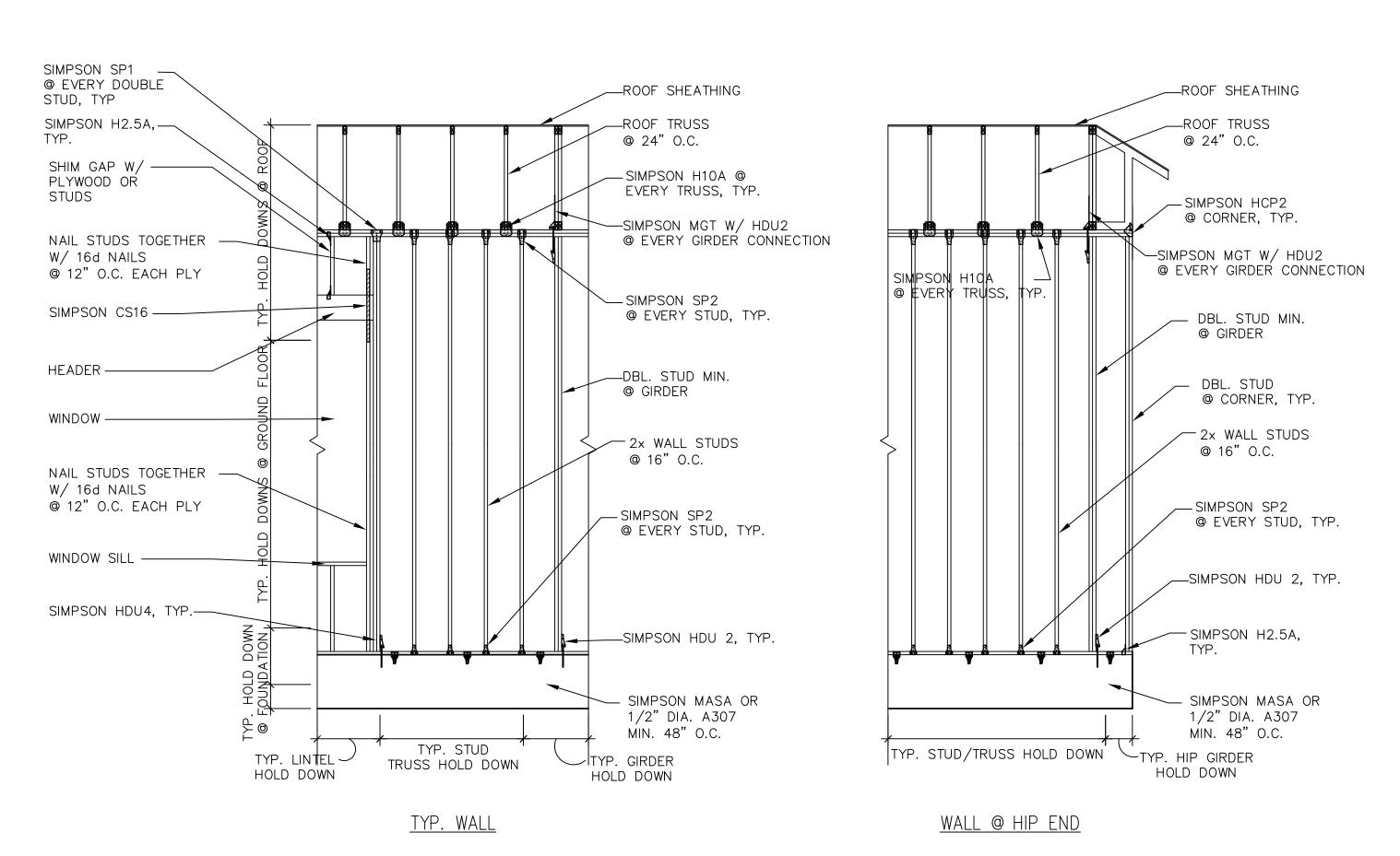
Typ. 1 Story Brg. Stud Wall Hold Down (Exterior Side View)
